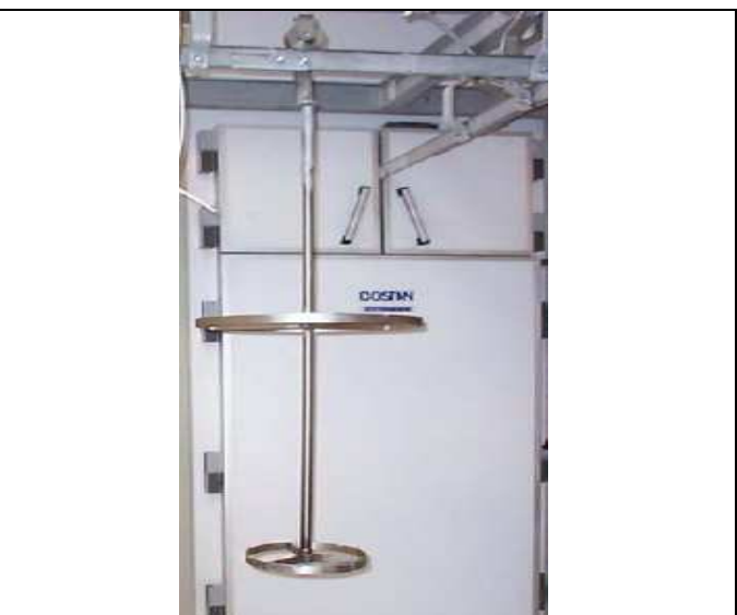
Fig. 28 – giostra a 2 livelli ergonomica (altezza superiore a ca 150 cm)
