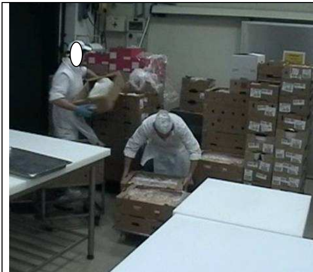
Fig. 5 – esempio di spazi inadeguati per uso corretto del carrello elevatore e per la movimentazione ergonomica dei carichi (necessità di misura di prevenzione)
