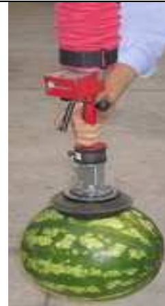
Fig. 15 – apparecchio di sollevamento a vuoto di anguria tipo crimson
