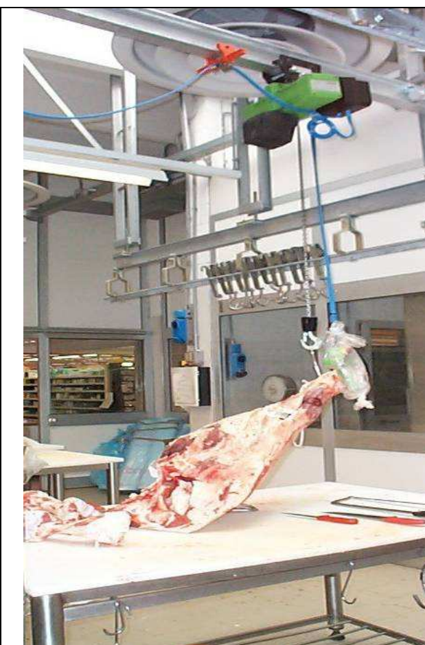
Fig. 12 – apparecchio di sollevamento (interno) di quarti e mezzene per passaggio da guidovia a banco di taglio
