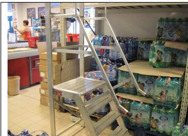
Fig. 33 – idonea scala a palchetto (alluminio) per spostare i pacchi di acqua/bibite o cartoni sul ripiano più alto
