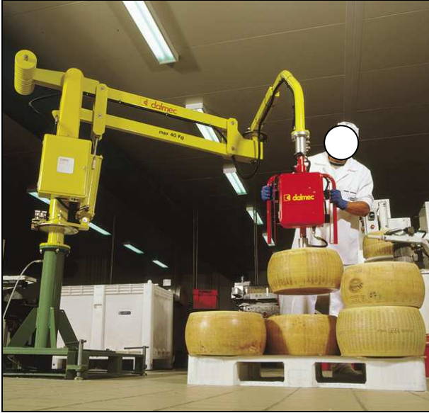
Fig. 14 – manipolatore con presa laterale della forma sullo scalzo
