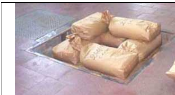
Fig. 7 e 8 – esempio di pedana industriale elevabile interrata che consente di migliorare l'altezza di presa della merce da movimentare quando arriva nelle condizioni di figg. 9 e 10)
