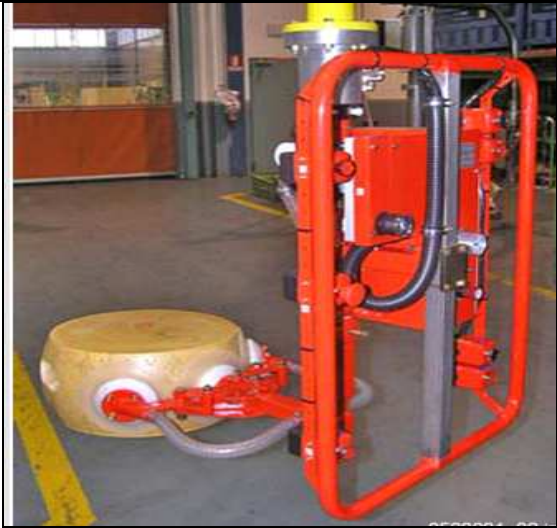
Fig. 14 – manipolatore con presa laterale della forma sullo scalzo
