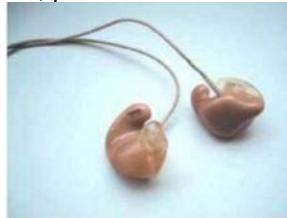
Figura 5. Monitor intrauricolari personalizzati (Fonte: Linee guida europee [1]).
